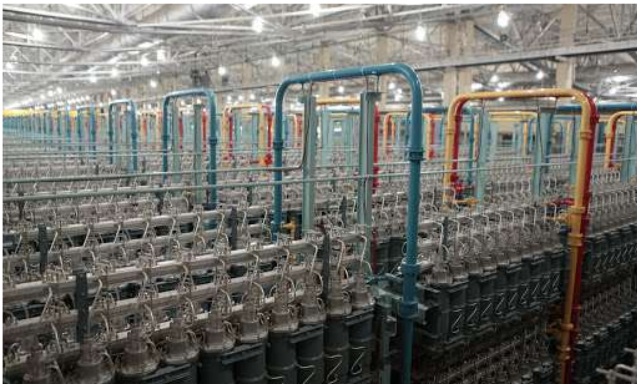
Рисунок 1.5.2 – Обогащение урана по газоцентрифужной технологии
